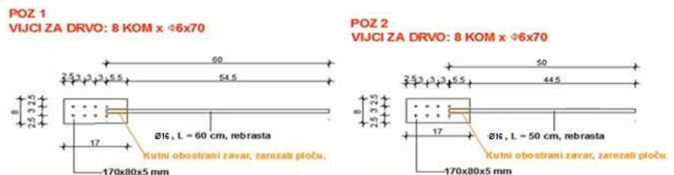
Slika 39. Detalj povezivanja stropa sa zidovima (ubušeni sidreni armaturni ankeri)
